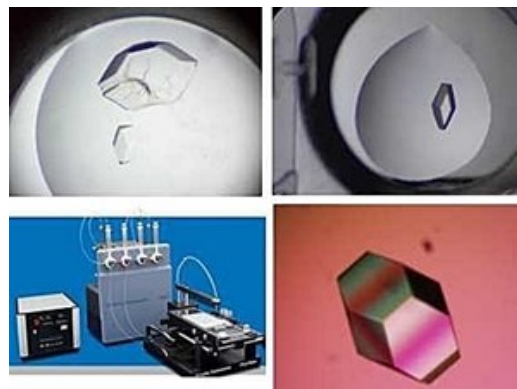
Κρύσταλλος λυσοζύμης μετά την επίδραση τεχνολογίας ασύρματης μικροηλεκτροδιέγερσης και το ρομποτικό μηχάνημα κρυστάλλωσης πρωτεϊνών
