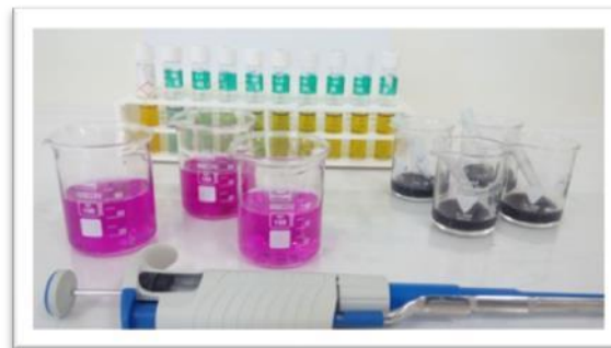
Δείγματα COD, NO 2 —N και απορρόφησης χρώματος
